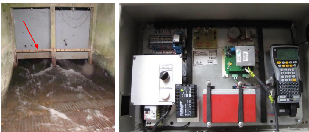
Fig. 31 : Dispositif RFID de Poltrou : antenne (g.) et boîtier enregistreur (d.)
