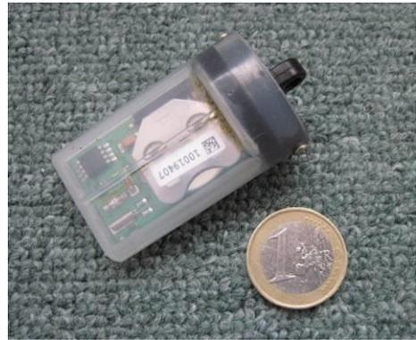
Fig. 17 : Sonde autonome Hobo
