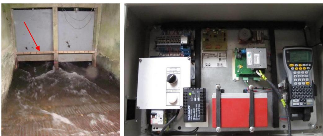
Fig. 31 : Dispositif RFID de Pol trot : antenne (g.) et boîtier enregistreur (d.)
