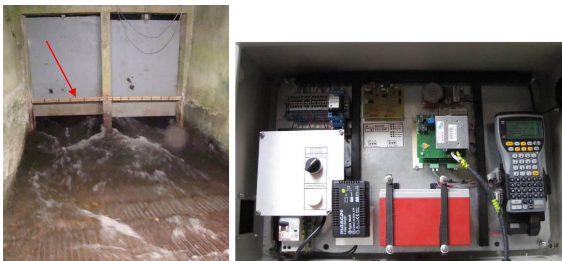
Fig. 40 : Dispositif TIRIS de Poltrot : antenne (g.) et boîtier enregistreur (d.)
