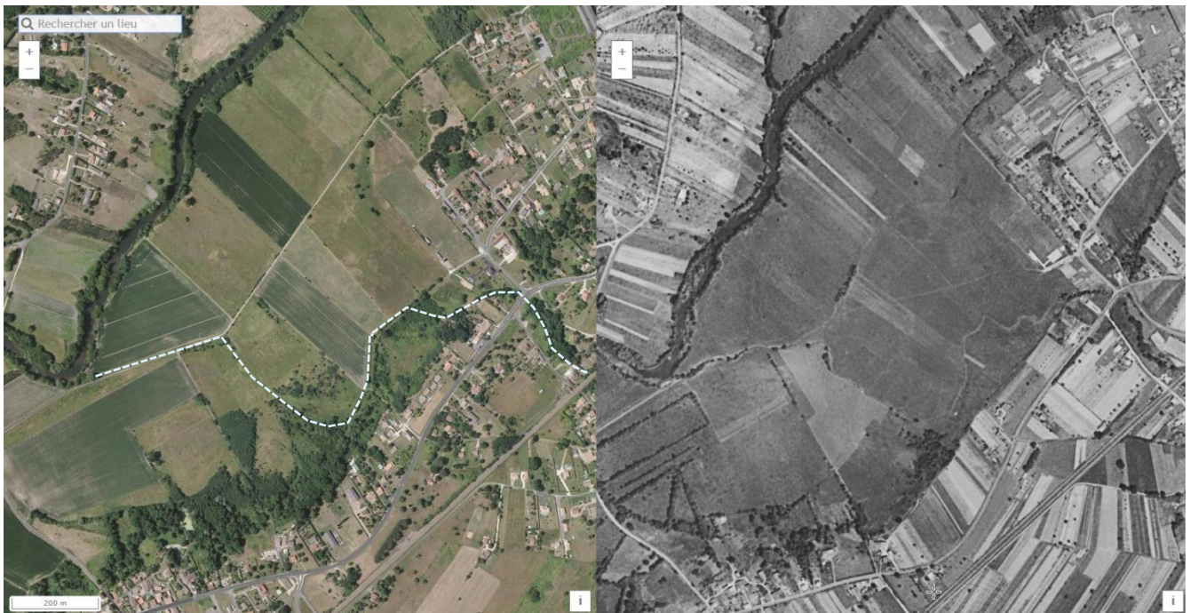
Aval du Malibeu à la confluence avec la Dronne entre 2015 (à gauche) et 1959 (à droite) : recalibrage du cours d'eau
